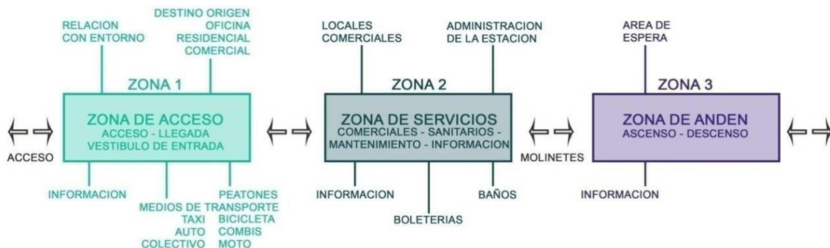
Figura 4 - Diferenciación de zonas dentro de una estación
